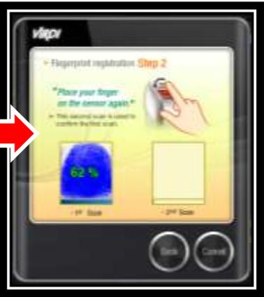
Quando o morador for realizar a coleta E usar no equipamento, oriente-o a sempre deixar o dedo centralizado e pressionar moderadamente e esperar uma resposta do equipamento.
